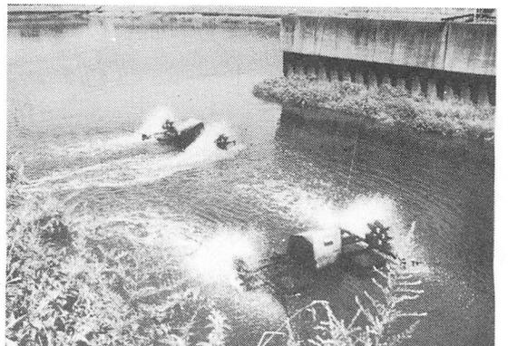
フロート上に固定された電動モーターによる水車。これによる酸素供給が、生物浄化の機能を促している。水車は、ロープで岸に係留されている。
